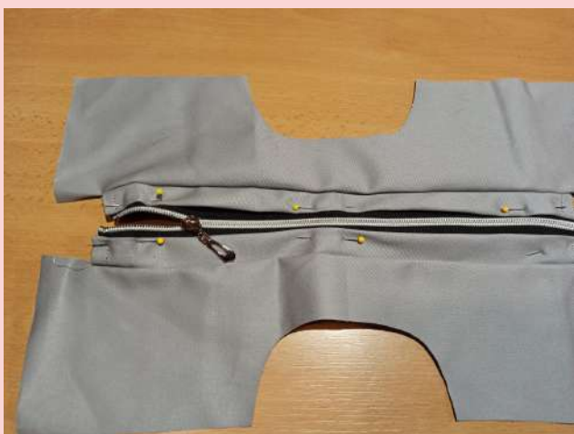
45. přišpendlíme zip i na druhou stranu, zapneme zip a srovnáme/přešpendlíme lišty (někdy to na jedné straně ujde). Rozepneme zip a přišijeme ho.
